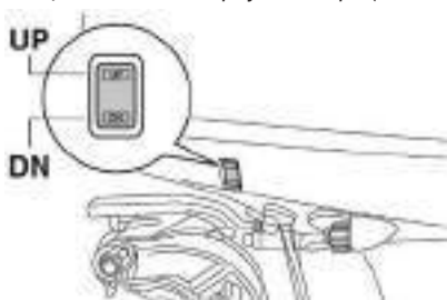
Рис. 38 Кнопка управления подъемником на корпусе мотора
