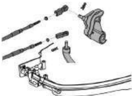
Рис. 14 Подключение тросов к мотору
