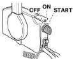
Рис. 29 Положения ключа зажигания
