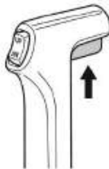
Рис. 27 Разблокировка рычага управления
