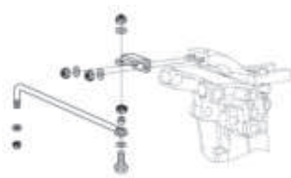
Рис. 18 Установка рулевой тяги
