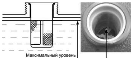
Рис. 22 Максимальный уровень топлива во внешнем баке
